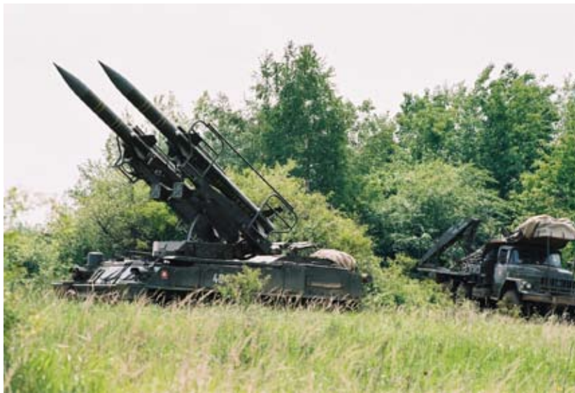
Obrázok 31: Protiletadlový systém 2K12M KUB krátkého dosahu v palebnom postavení, ktorý je predurčený na ničenie manévrujúcich vzdušných cieľov
